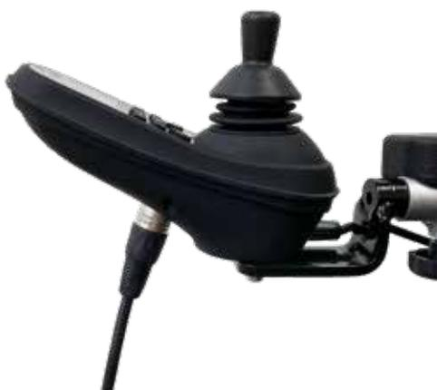
di ricarica devono essere eseguite per circa cinque ore nel caso in cui la barra dell'indicatore della batteria sul joystick sia scesa di tre linee.
